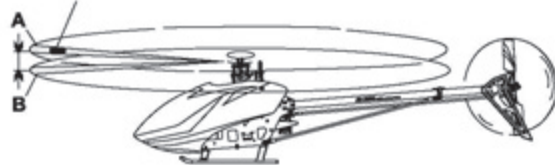
Color Mark 有標示記號的主旋翼
